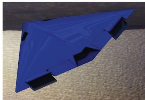
BILD 1. Möglicher Einsatz einer formvariablen Klappe am SAGITTA Demonstrator
