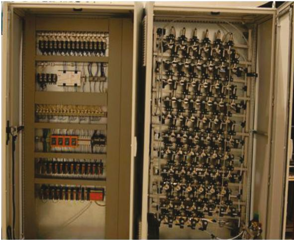
BILD 9. Druckmess-Schrank mit 64 Kanälen und automatisierter Spülvorrichtung
