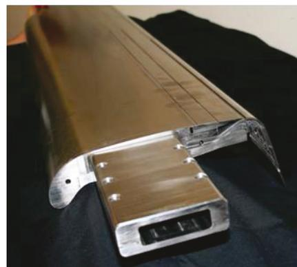
BILD 11. Das Profil für aktiven Hochauftrieb; (Links): CAD-Konstruktion vier Modulen; (Rechts) Fertiges Modell, im Vordergrund der massive Holmstummel, der auch als Wasserzuführung genutzt wird.
