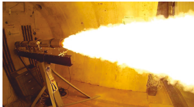
BILD 18. Heißlauf des Oberstufenmotors
