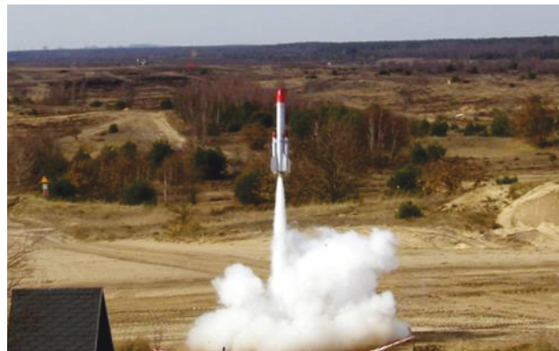
BILD 19. Start der B4-1-AQUARIUS-Heißwasserrakete [4]
