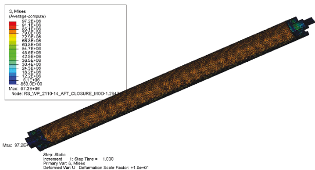
BILD 8. Ergebnisse der FEA des Motorgehäuses
