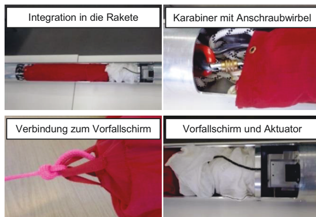
BILD 14. Detailansicht des Bergungssystems
