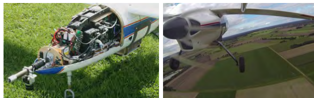
BILD 12: Ausrüstung des Flugzeugs mit Kamera und Rechnern (links), Beispielbild aus einer weiteren Bordkamera im Flug (rechts).
