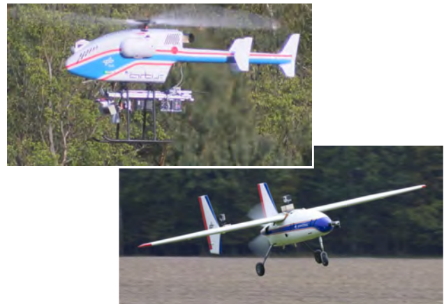
BILD 1: Unbemannte Versuchsträger am DLR: Hubschrauber super-ARTIS (Flettner-Doppelrotor mit 2x 2,8m Rotordurchmesser, 85 kg MTOM) und Flugzeug Prometheus (Spannweite 3,2m, 31 kg MTOM).
