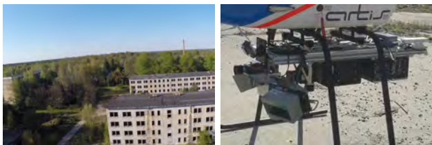
BILD 9: Flugversuchsgelände (links), Ausrüstung des Hubschraubers (s. Bild 1) mit Kameras und Laserscannern (rechts).
