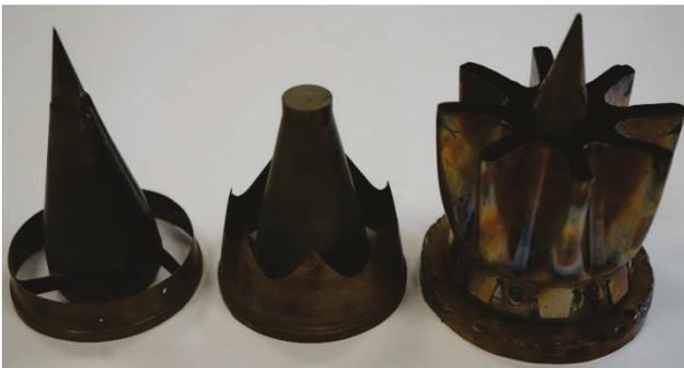
BILD 8: Düsenformen kleine Schubtriebwerke: gerade (l), Chevron (m), Blütenmischerdüse (r)
