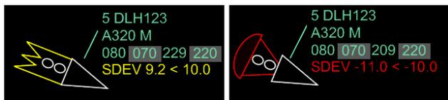
BILD 6. Geschwindigkeitsabweichung im HMI (zu schnell bzw. zu langsam) in [K7]
