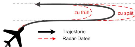
BILD 17. Zu frühes und zu spätes Eindrehen auf die Centerline
