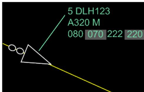
BILD 13. Ausgewähltes Luftfahrzeug ohne Abweichungen im HMI
