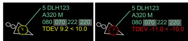
BILD 5. Zeitabweichung im HMI (zu früh bzw. zu spät) in [s]
