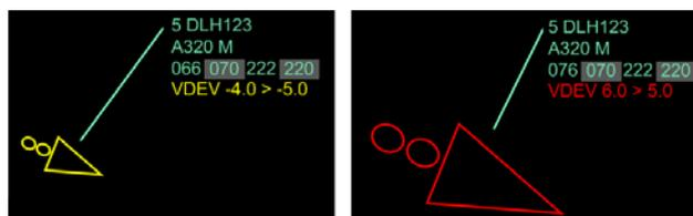
BILD 7. Vertikale Abweichung im HMI (zu niedrig bzw. zu hoch) in [FL]
