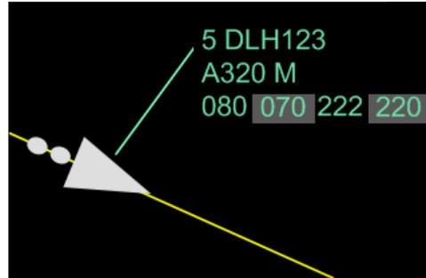
BILD 1. Anzeige eines Luftfahrzeugs im HMI
