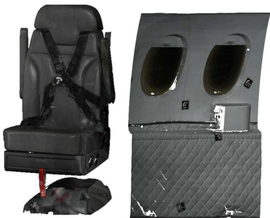
BILD 19. Kabinenkomponenten am Beispiel der Sitze und Seitenverkleidung
