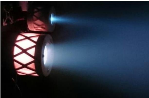
BILD 8: Testdurchführung des BIT-3 Antriebes von Busek Co. Inc. mit Xenon [22].
