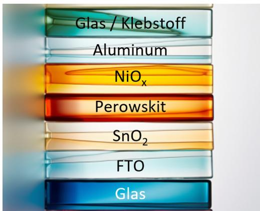
**BILD 2. Aufbau von Perowskit-Solarzellen für den Einsatz in der lunaren Umgebung.**
