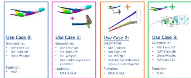
Abbildung 1: Übersicht der Konfigurationen in In-Fly-Tec
