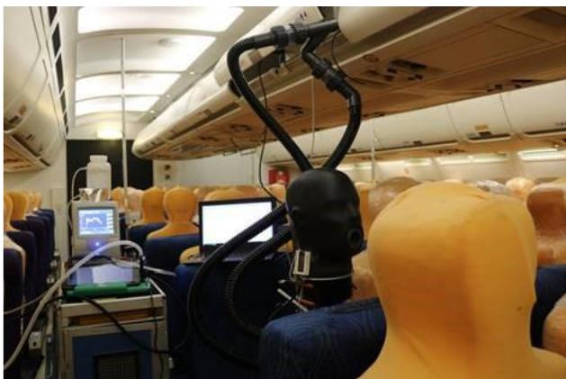
**Bild 3: Sheffield Kopf auf Sitz 4G mit Atemmaschine im Gepäckfach und Partikelmessgerät auf dem Trolley.**
