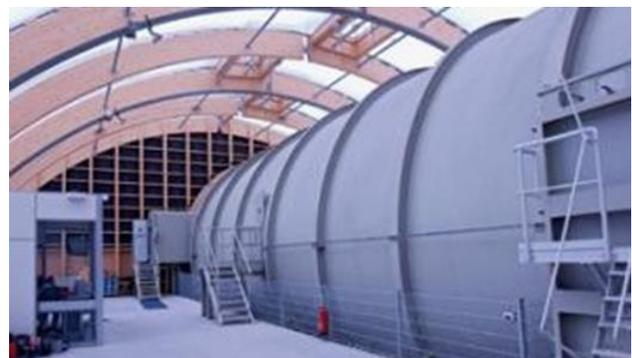
**Bild 1: Niederdruckröhre des Fraunhofer Fluglabors.**
